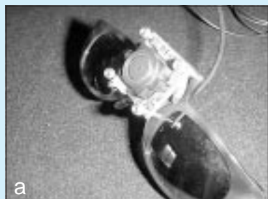
Figura 19 – Il sistema di ausilio per i non vedenti: (a) la microtelecamera, (b) il tappetino epidermico
